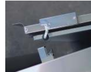
Sistema de Cierre con Freno Retenedor Lock System with Retention Break
